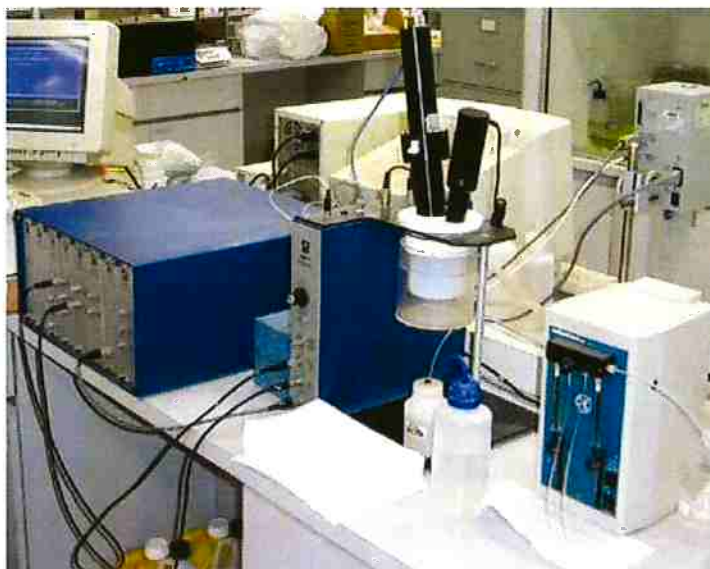
Figura 6.3 - Zeta Meter, Matec - modelo ESA 9800, utilizado no trabalho
