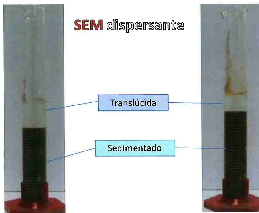
Figura 7.53 - Imagem do ensaio de sedimentação após 20 minutos do início para formulação sem (esquerda) e com (direita) resíduo de bauxita, ambos sem dispersante.
