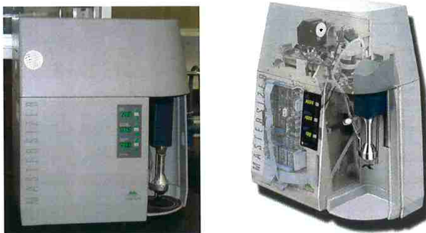
Figura 6.4 - Granulômetro a laser, Malvern – Mastersizer S long bed Ver 2.19, utilizado para caracterização dos diâmetros de partículas.
