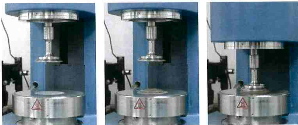
Figura 6.7 - Reômetro AR550, TA Instruments, utilizado para realização dos ensaios de fluxo e oscilatório das pastas e das espumas aquosas.
